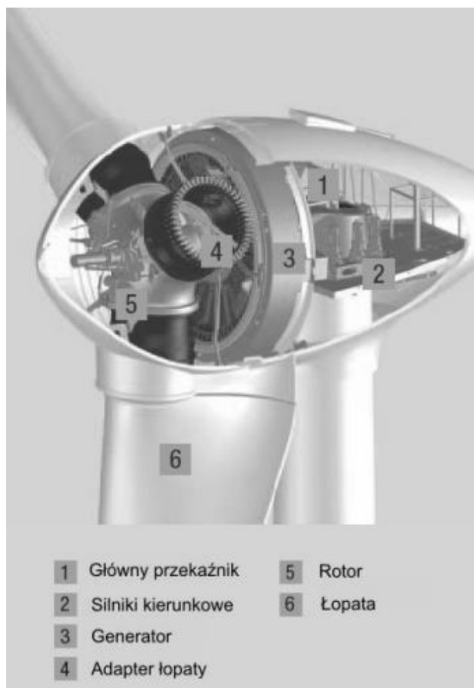
Rysunek 9 Schemat budowy elektrowni wiatrowej.
