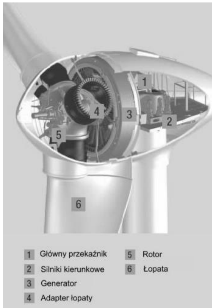
Rysunek 9 Schemat budowy elektrowni wiatrowej.
